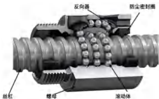
图14：滚珠丝杠结构
