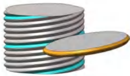
图34: 砂轮磨削加工外螺纹螺旋面
