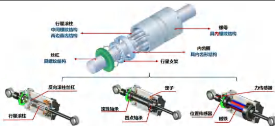
图9：行星滚柱丝杠及相关构造拆解
