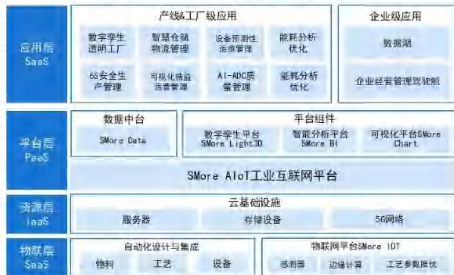
图：思谋SMore AIoT工业互联网平台系统架构
